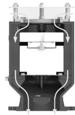
Впуск в систему большого объема воздуха.
