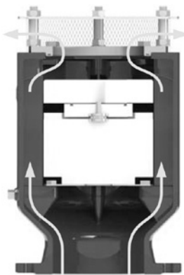
Удаление воздуха в процессе обычной работы системы.
