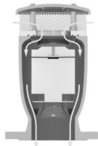
Впуск в систему большого объема воздуха.
