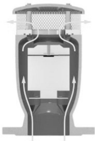
Выпуск в систему большого объема воздуха.
